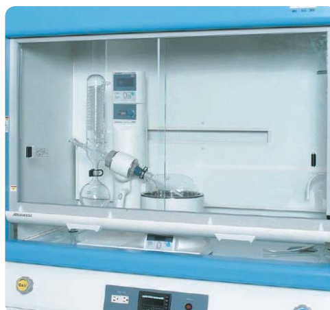
減壓濃縮機可安裝在實驗通風櫥內， 儘管400mm深度，但直立式冷凝器 (玻璃器皿B / C) 不佔用空間。
